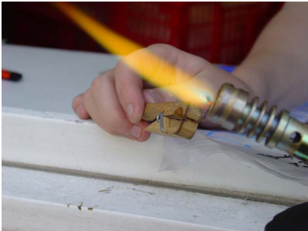
Abbildung 2-3: Kupferdraht wird in der Bunsenbrennerflamme ausgeglüht
